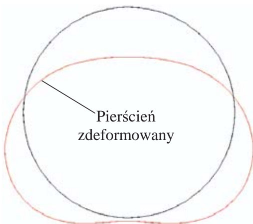
Rys. 3.12. Kształt pierścienia w wyniku deformacji ( W_{max}=0.238 [m])po czasie t=0.22 [s] Fig. 3.12. The shape of the ring as result of the deformation ( W_{max}=0.238 )[m]after the time t=0.22 [s]
